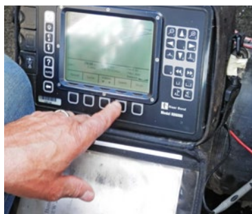
Messgerät zur Bestimmung der Drahtlänge: Laufzeitmessgerät
